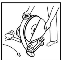
4. Überprüfen Sie regelmässig den Zustand des Pad und wechseln Sie die Padseite oder das Pad falls dieses stark verschmutzt ist. Sicherheitshinweis: Ziehen Sie den Stecker bevor Sie den Zustand des Pads prüfen. Falls erwünscht: Polieren Sie die gesamte Oberfläche mit einem sauberen Pad. Falls erforderlich entfernen Sie anschließend den losen Schmutz vom Boden.
