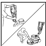
6. Reinigen Sie die Maschine und das Kabel mit einem feuchten Tuch. Wickeln Sie das Kabel lose auf. Reinigen/ waschen Sie das Pad.
