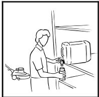
1. Entfernen Sie zunächst losen Schmutz. Überprüfen Sie den technischen Zustand der Maschine und montieren Sie ein sauberes Pad. Füllen Sie das Reinigungsprodukt gemäss Herstellerempfehlung in die Sprühflasche. Stellen Sie das Warnschild auf.
