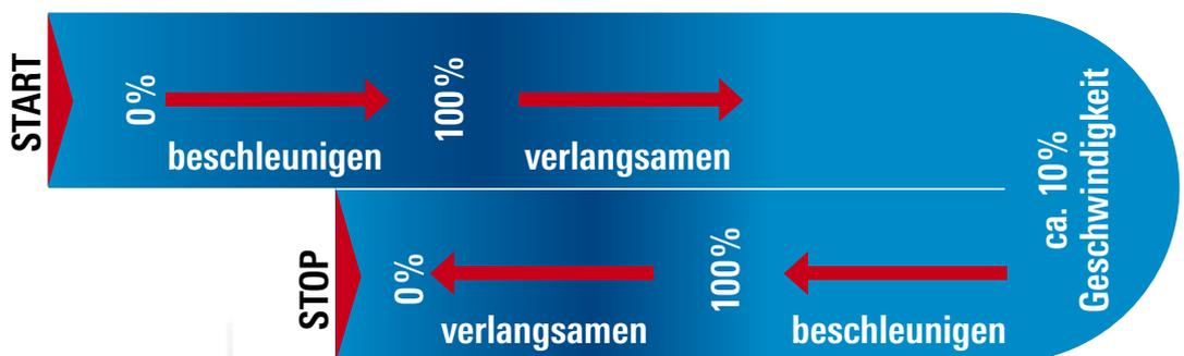
Beim Beschleunigen oder Verlangsamen wird die Zufuhr der Reinigungsflotte automatisch angepasst. Eine Über- oder Unterdosierung ist nicht möglich.
